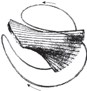
图 9-15 一种“棒球线圈”拓扑地等价于具有约飞棒的简单磁镜
